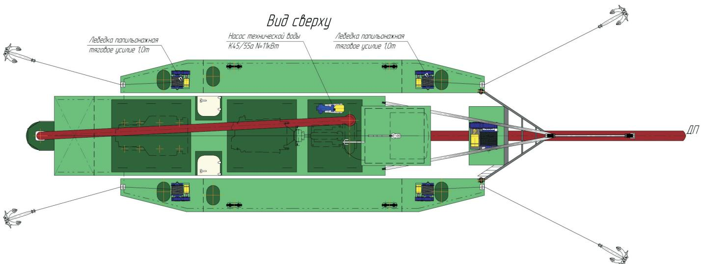
Назначение земснаряда – добыча материалов (строительные песок, гравий, ПГС и прочее), очистка водоемов от наносов, производство дноуглубительных работ, разработка подводных траншей, способом гидрорыхления.
