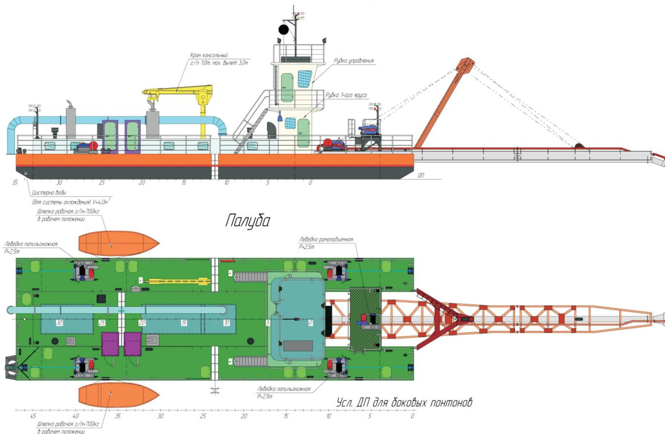
Тип судна – плавучий, несамостоятельный, дизельный, сборно-разборный земснаряд с гидрорыхлением производительностью по воде 1600 м<sup>3</sup>/ч. Назначение земснаряда – разработка грунтов I-III категории способом гидрорыхления и транспортирования пульпы по пульпопроводу на отвалы, обогатительные установки и карты намыва.
