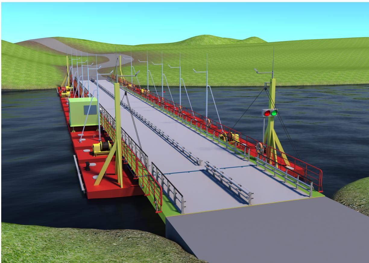
**Архитектурно-конструктивный тип** – секционно-разборное сооружение понтонного типа, состоящее из двух звеньев, одного берегового правого и одного выводного левого. Каждое звено состоит из отдельных плавучих понтонов, объединенных между собой верхним пролетным строением.
