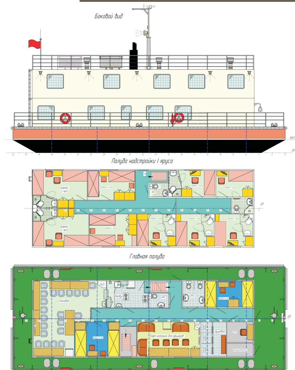
Тип судна – несамоходное, стальное, плавучее сооружение с корпусом pontонного типа, с расположенной на главной палубе двухъярусной надстройкой, дизель-генераторным и насосным отделениями в корпусе судна.
