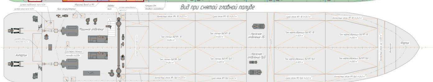
назначение - прием с судов и транспортировка к местам переработки нефтесодержащих (без ограничения по температуре вспышки), сточных вод и сухого мусора.
