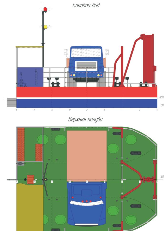
Тип судна - несамоходный, стальной, однопалубный двухкорпусный понтон без надстройки, предназначенный для перевозки не более 12 человек под навесом и одного автомобиля (массой до 5т).
