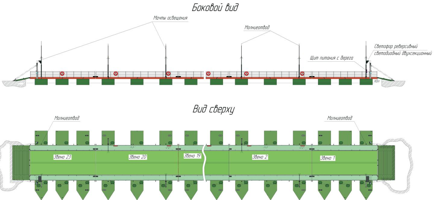
Наплавной мост предназначен для двухстороннего движения в одну полосу легкового автотранспорта, одностороннего регулируемого движения грузовых и грузопассажирских автотранспортных средств допускаемой массой 32 т и двухстороннего движения пешеходов.
