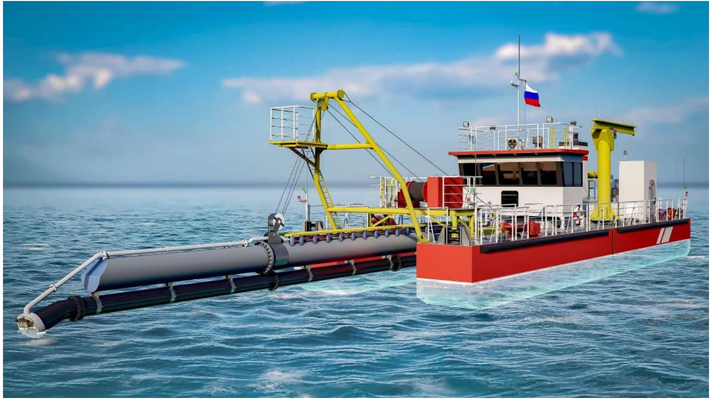
**Тип судна** – несамоходный сборно-разборный землесосный снаряд с гидравлическим рыхлителем и тросовым папильонажем.
