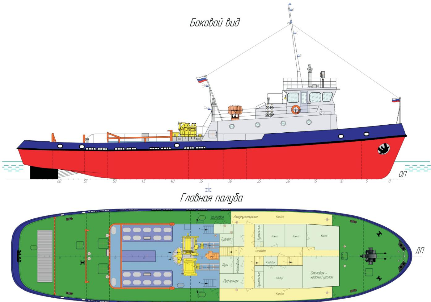
Тип судна – двухвальный буксирный теплоход с одноярусной надстройкой.
