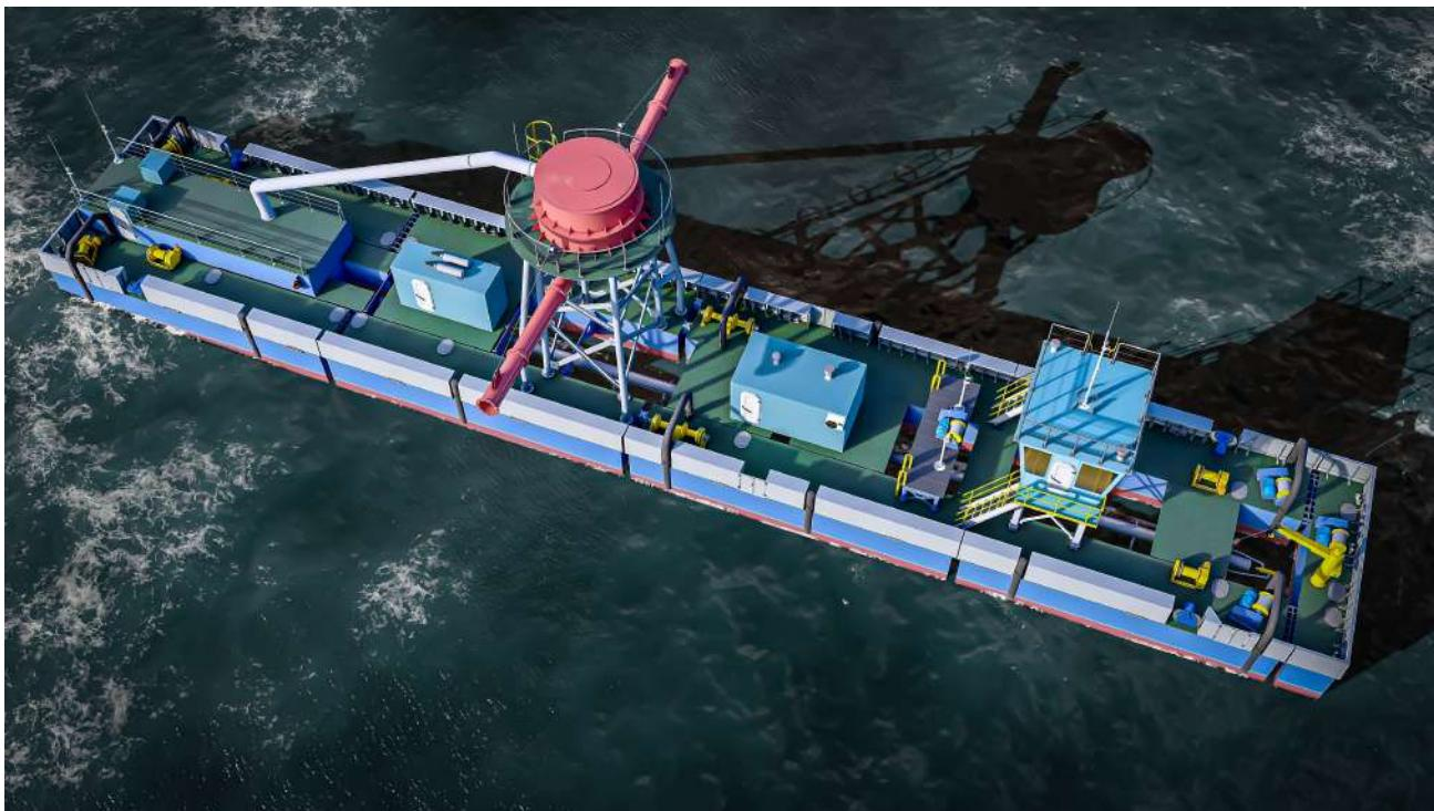
**Тип судна** – плавучий, несамоходный, модульный, сборно-разборный, дизельный с гидравлическим рыхлением и эжектированием землесосный снаряд производительностью по пульпе 4000 м<sup>3</sup>/ч с разборным металлическим корпусом и съемной рубкой управления и гидроклассификатором.
