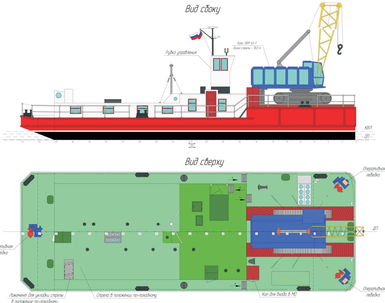
Несамоходный дноочистительный снаряд максимальной грузоподъемностью 7,5 т, предназначен для очистки русла рек от карчей, камней, затопленных якорей и пр., а также для очистки берегов, погрузки и выгрузки материалов для выправительных работ.
