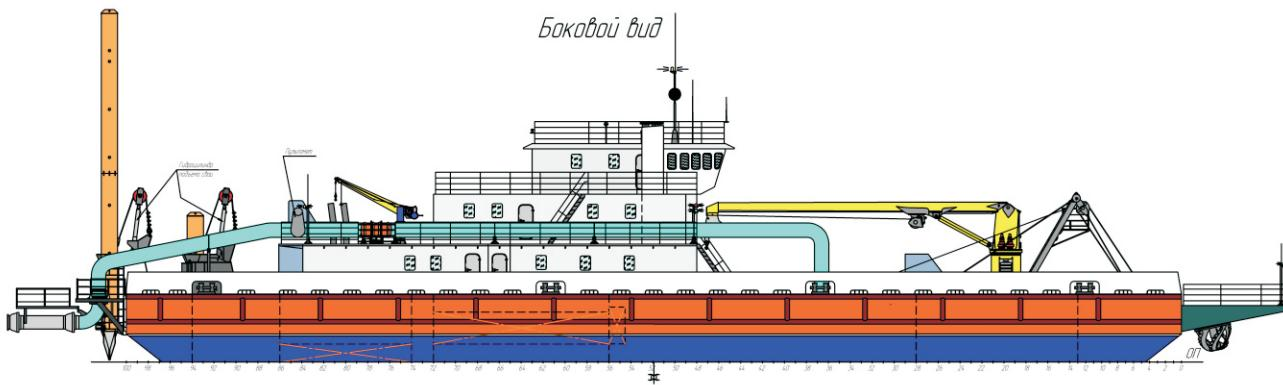
Тип – земснаряд дноуглубительный несамоходный с гидравлическим и фрезерным рыхлителями.
