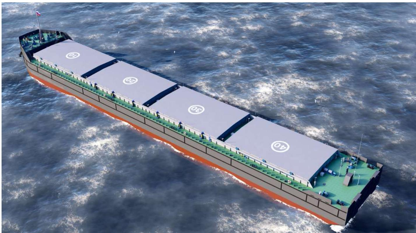
**Тип судна** – несамостоятельная трюмная баржа с баком, четырьмя грузовыми трюмами, оборудованными непроницаемыми лючковыми закрытиями.
