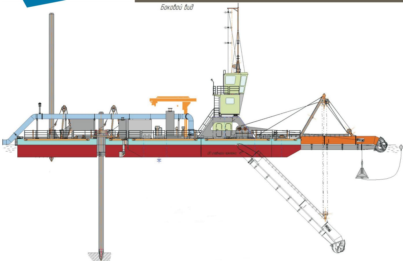
Тип судна – плавучий, несамоходный, модульный, сборно-разборный, дизельный с фрезерным рыхлением землесосный снаряд (земснаряд) производительностью по пульпе 4000 м<sup>3</sup>/ч с разборным металлическим корпусом, съемными надстройками и рубкой управления.
