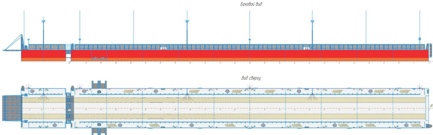
Наплавной мост предназначен для одностороннего регулируемого с помощью светофоров движения легковых, грузовых и грузопассажирских автотранспортных средств, допускаемой массой 75 т и двухстороннего движения пешеходов.
