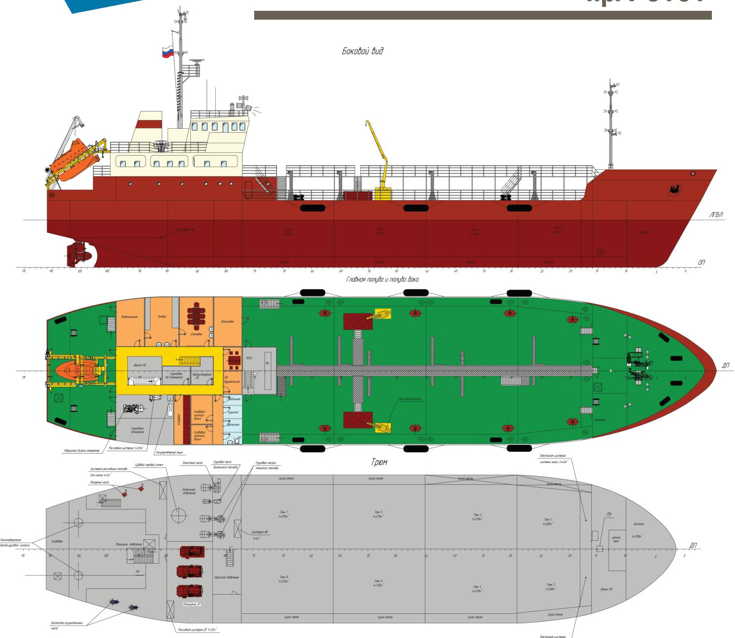
Назначение судна - транспортировка и бункеровка нефтепродуктов с температурой вспышки выше 60 град. С в портах, на рейдах и на устьевых участках рек. Предусмотрены: двухвинтовые ВРК, двойные борта и двойное дно, надстройка в корме, МО, расположенная в кормовой части, НПУ в носовой части. Корпус разделен на 8 танков. Функционирование судна предусмотрено только в пределах внутренних вод России.
