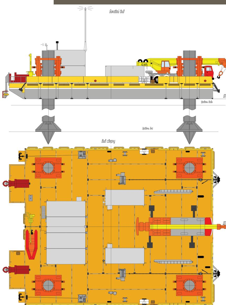
Назначение - многофункциональная модульная площадка для выполнения буровых работ не связанных с добывчей ресурсов, методом горизонтального бурения, грузовых операций, прокладки дюкеров и т.п. в прибрежной морской 20-мильной зоне на глубинах до 32 м, а также на внутренних водных путях. Эксплуатация в ледовых условиях не предусмотрена.
