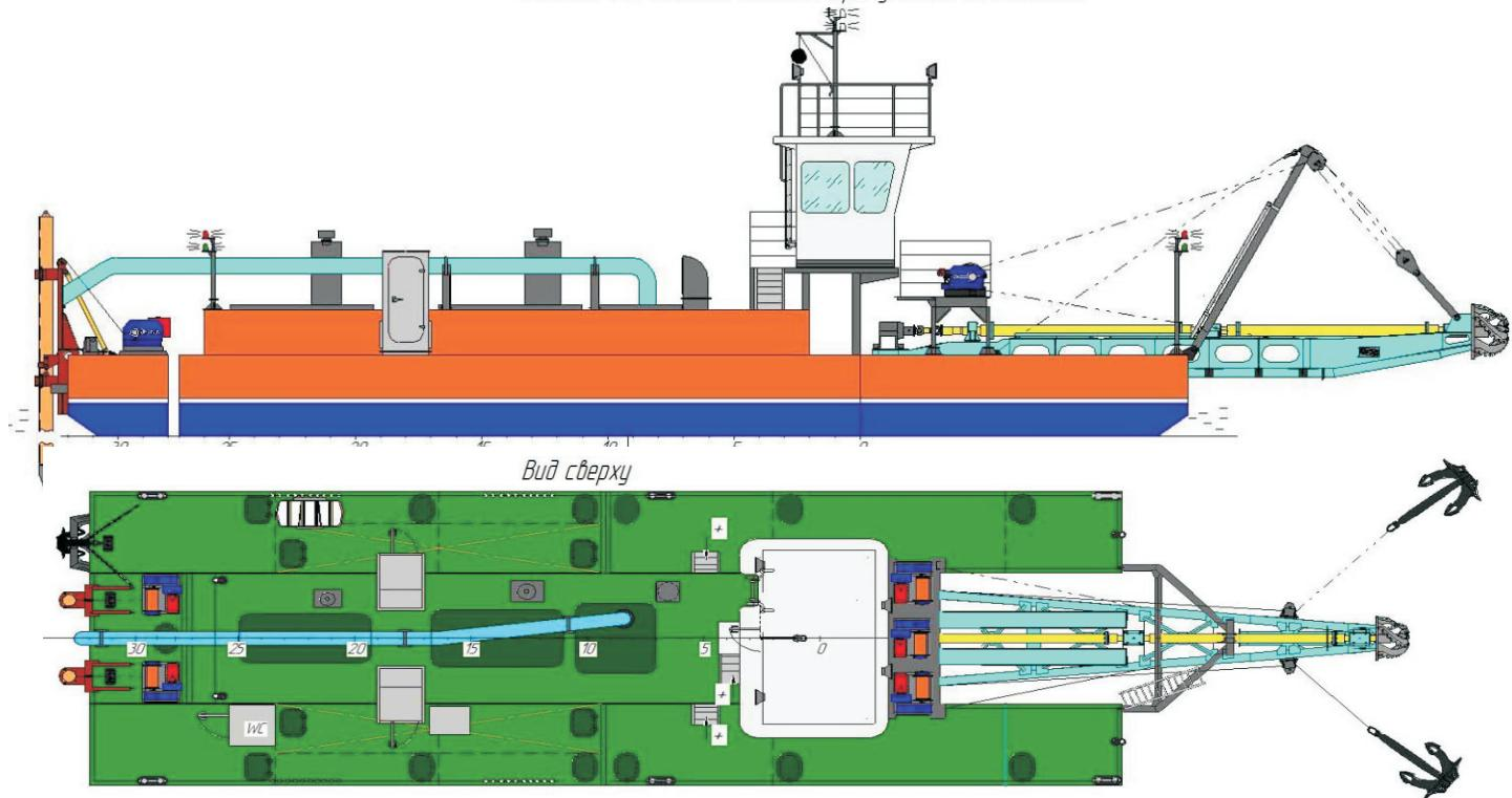
Тип земснаряда – плавучий, несамоходный, дизельный, сборно - разборный земснаряд с фрезерным рыхлением, производительностью по воде 1400 м<sup>3</sup>/ч по пульпе, с возможностью перевозки железнодорожным, автомобильным и водным транспортом. Судно предназначено для подводной разработки грунта I-VI категории, согласно ФЭР 2001-01 таблица 1-4, и транспортирования его в виде водогрунтовой смеси, по трубопроводу, к месту укладки.
